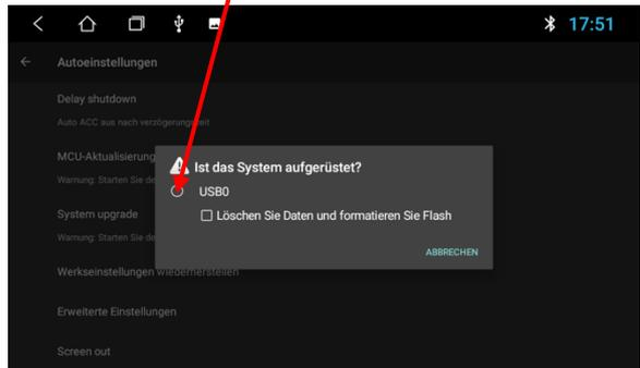
Das Update wird gestartet. Das folgende Fenster wird angezeigt. Dann wird das Autoradio neu gestartet. Nach dem Neustart des Systems ist das Update abgeschlossen.
